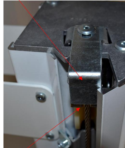
Nach dem Aufstellen der Pylonen sicherstellen, dass die Nicopressklemmen des Seils an der Umlenkrolle auf der Oberseite der Pylone richtig in der Nut eingehängt ist.
