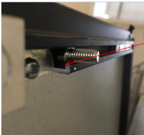
An der hinteren Umrandung des Boards befindet sich eine Nut mit verschiedenen Öffnungen. Schrauben durch die Öffnungen bis zur gewünschten Position in die Nut einführen.
